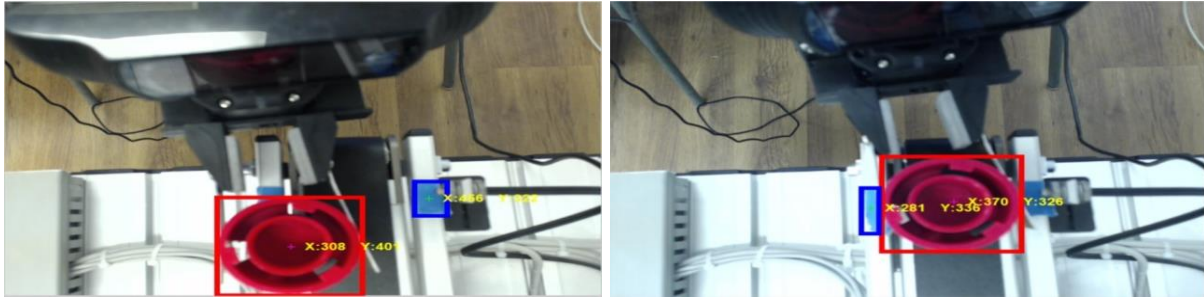
Fig.4.35. Imagine în timp real în care RM Cyton 1500 predă piesa pe P/RML pentru reprelucrare
