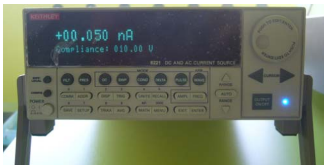
Figura 3.1. Sursa de curent constant cu picoampermetru Keithley 6221.
