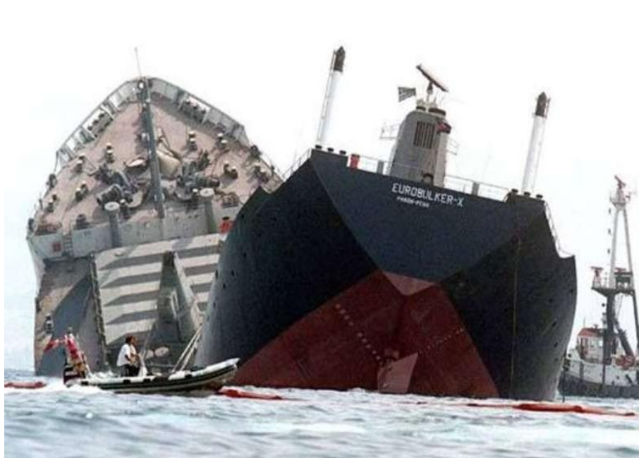
Fig. 1.1.3 – Vrachierul EUROBULKER-X după ruperea din 02.septembrie.2000, în timpul încărcării cu ciment în portul Lefkandi din Grecia [8]
