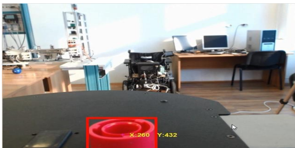
Fig. 5.14.c - Recuperare piesă utilizând VS mobil
