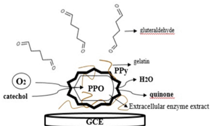
Figura 11.16. Conceptul de operare al biosenzorilor pentru catechol bazați pe extract enzimatic TP simplu sau modificat cu Ppy și immobilizat pe suprafața unui electrod de carbon vitros (GCE).
