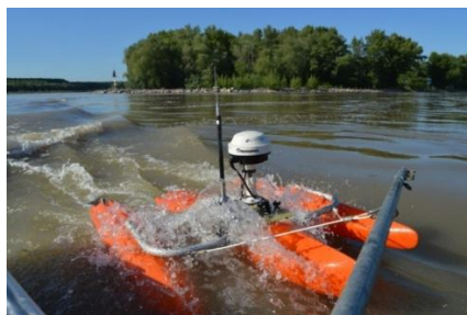
Figura 5.5 Măsurătoare single beam a albiei în zona de amplasare a stațiilor de monitorizare
