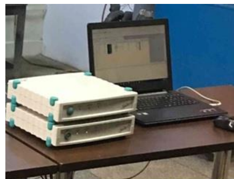
Fig. 5.30. Echipamentul pentru achizițiile de date ale tensiunilor (preluare din [223])
