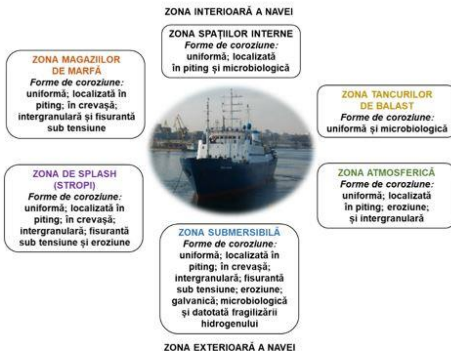
Fig. 1.18. Zonele de coroziune la o navă maritimă (imagine prelucrată din [114...116])
