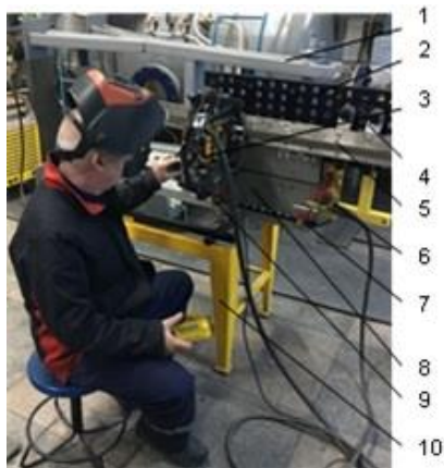
Fig. 2.6. Stand pentru sudarea mecanizată MAG-M în poziția incomodă PC (imagine preluată din [166])
