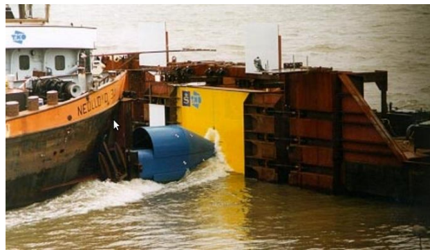
Fig.1.23. Experiment de coliziune realizat în Olanda în anul 1998 [6]
