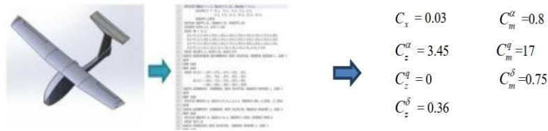
Fig. 3.23. Determinarea derivatelor de stabilitate ale UAV-ului cu ajutorul software-ului DatCom
