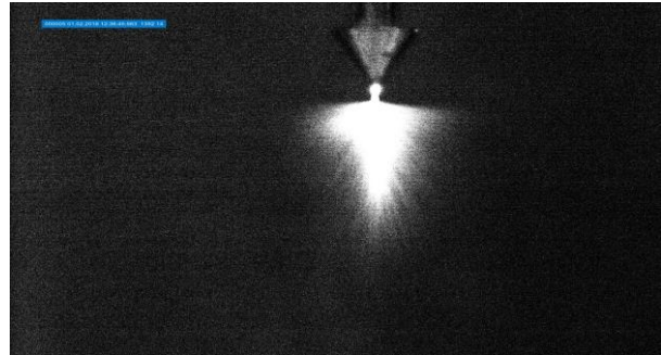
b) Descărcarea Corona generată în laborator (Set date 2)
