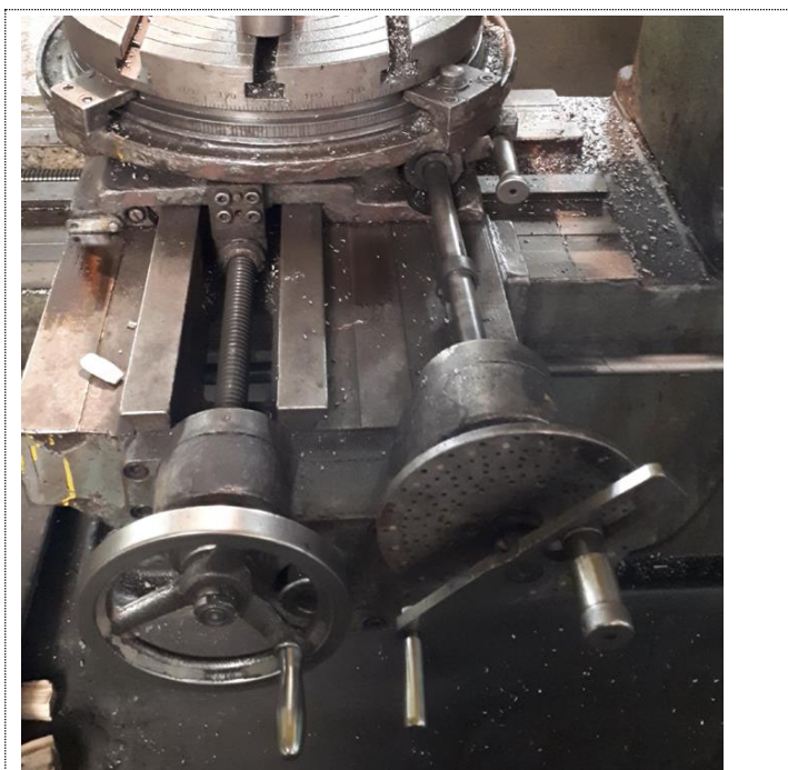
Fig. 7.4 Mecanismul de acționare manuală a mesei
