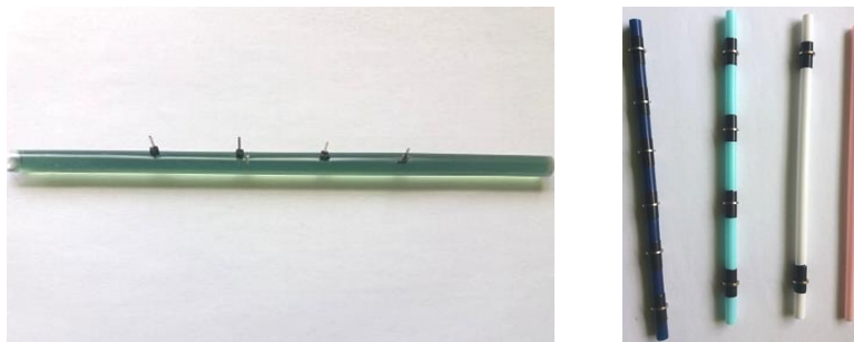
Figura 14. Epruvetă cu pini (pentru determinarea rezistenței electrice) și matrițe cu magneți inelari
