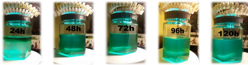
Figura 55. Aspectul amestecului pre-polimeric (NF) înainte de adăugarea întăritorului
