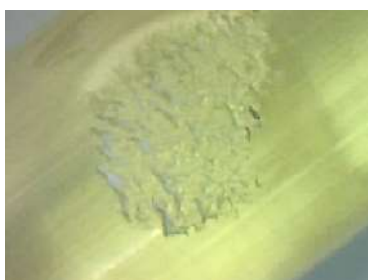
Figura 3. 9. Uzura apărută pe contrapiesă.
