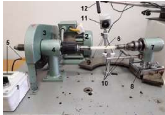
Figura 2. 3. Stand de testare la oboseală.
