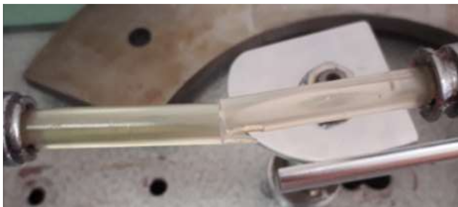
Figura 3. 2. Forma rupturii epruvetelor RTT, îndoite la peste 15-16 grade.
