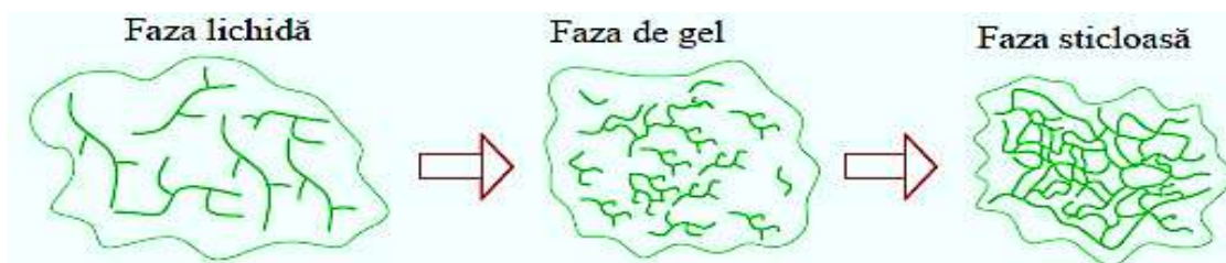
Figura 2. 7. Fazele de transformare a matricei polimerice. [75]
