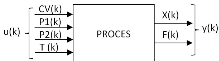
Fig. 5. 3 - Modelul procesului cu intrările u(k) (4 mărimi de intrare) și ieșirea y(k) (2 mărimi de ieșire)
