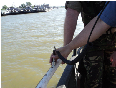
Figura 4.26 Măsurarea vibrațiilor balustradelor cu Examiner
