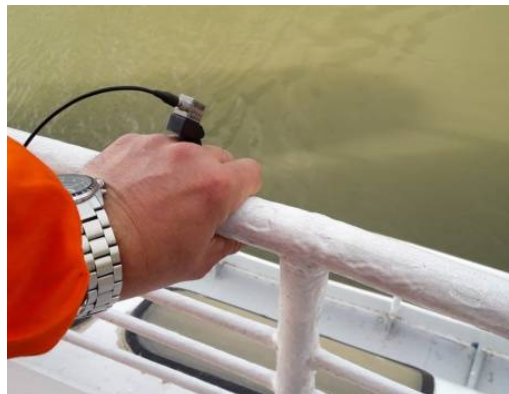
Figura 4.67 Accelerometrul triaxial plasat pe deget prin intermediul suportului
