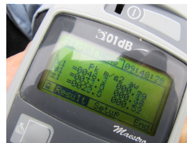
Figura 4.83 Măsurarea vibrațiilor transmise corpului în sala motoarelor cu Maestro
