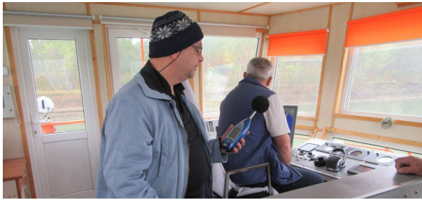
Figura 4.39 Măsurări de zgomot cu un sonometrul Blue Solo, în interiorul sălii de comandă
