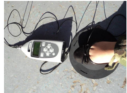
Figura 4.25 Măsurarea WBV pe puntea principală cu Maestro 01dB
