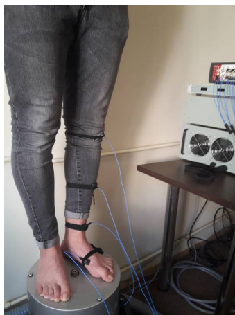
Figura 4.3 Subiect pe sistemul vibrant cu accelerometrele prinse de picior, gleznă și genunchi
