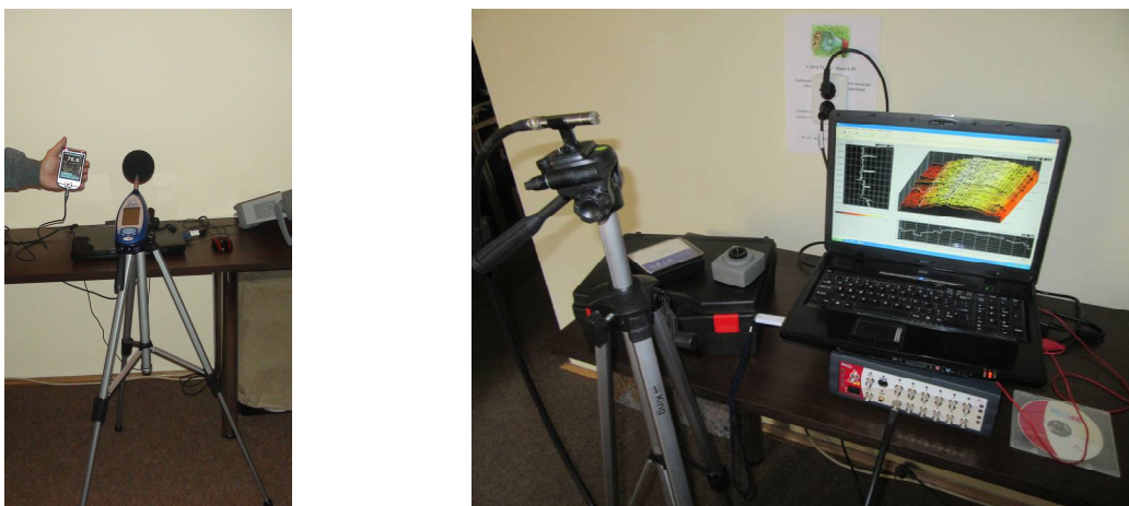
Figura 4.18 Determinări experimentale cu sonometrul BlueSolo
