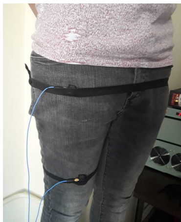
Figura 4.6 Subiect pe placă pe sistemul vibrant cu accelerometrele prinse de coapsă și șold
