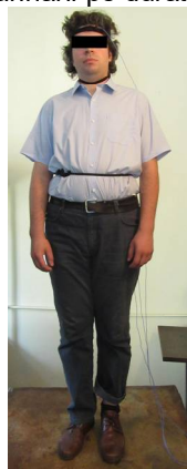
Figura 4.44 Subiect pe placa situată pe sistemul vibrant și dispunerea accelerometrelor
