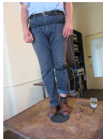
Figura 4.5 Subiect pe placă pe sistemul vibrant cu accelerometrele prinse de gleznă, genunchi și șold
