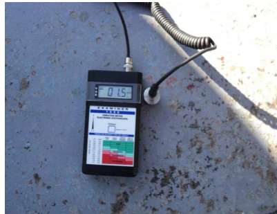
Figura 4.24 Măsurarea vibrațiilor transmise punții principale cu Examiner
