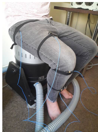
Figura 4.7 Subiect șezând pe sistemul vibrant cu accelerometrele pe pulpă, genunchi, coapsă și șold
