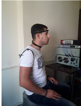
Figura 4.14 Subiect pe sistemul vibrant cu accelerometrele prinse de mână, umăr, cervicală și frunte
