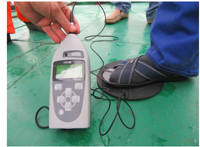
Figura 4.28 Măsurarea vibrațiilor întregului corp cu Maestro (WBV) și accelerometrul triaxial seat-pad
