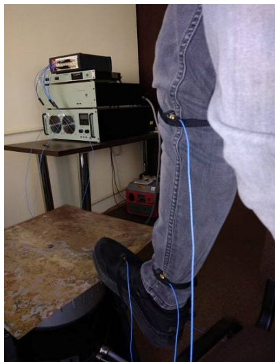
Figura 5.13 Configurația experimentală utilizată pentru evaluarea răspunsului piciorului uman supus unei excitații de tip vibrație mecanică
