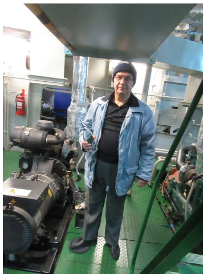
Figura 4.31 Măsurarea vibrațiilor transmise întregului corp (WBV) - sala motoarelor
