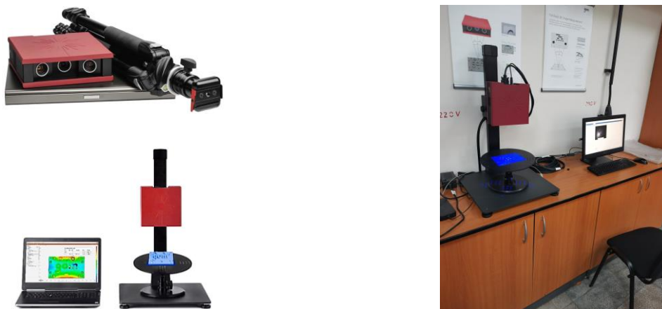
Fig. 5.1. Aparatul de scanare Atos Core [60,61]
