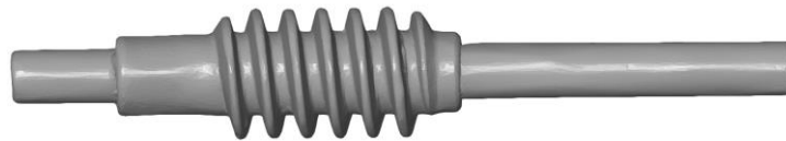
Fig. 5.11. Modelul scanat al arborelui melcat din construcția mecanismului de ajustare a scaunelor unui autoturism marca Mercedes
