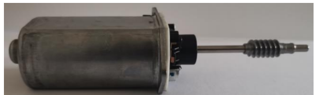
Fig. 5.9. Arborele melcat din construcția mecanismului de ajustare a scaunelor unui autoturism marca Mercedes
