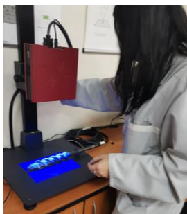
Fig. 5.5. Scanarea celor doi rotori din componența unei pompe elicoidale
