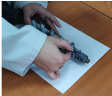
Fig. 5.4. Aplicarea markerilor de referință pe rotorul conducător și rotorul condus
