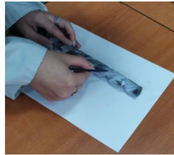
Fig. 5.4. Aplicarea markerilor de referință pe rotorul conducător și rotorul condus
