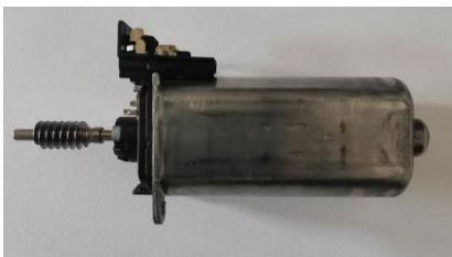
Fig. 5.8. Arborele melcat din construcția mecanismului de ajustare a scaunelor unui autoturism marca Audi
