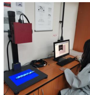
Fig. 5.5. Scanarea celor doi rotori din componența unei pompe elicoidale
