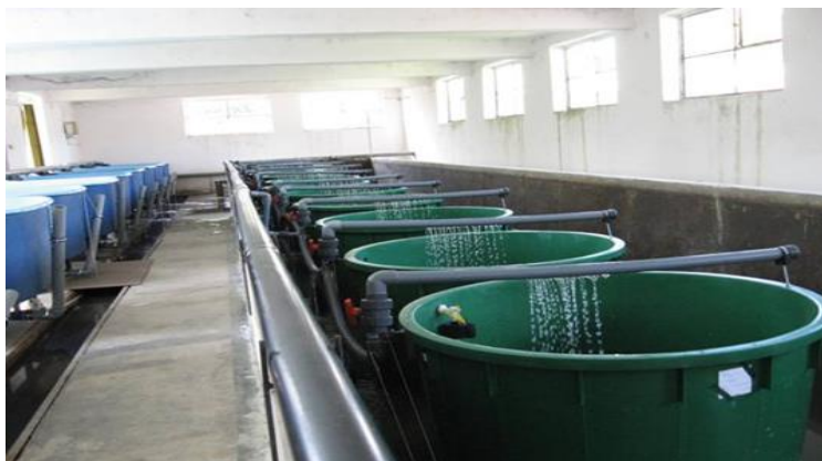
Figura 13. Instalație pilot (căzi „Evos”) pentru creșterea și dezvoltarea larvelor de șalău în perioada de alevinaj (foto original)
