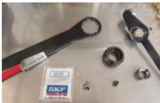
a) Cupa bilelor cu componentele de fixare și pârghia de strângere
