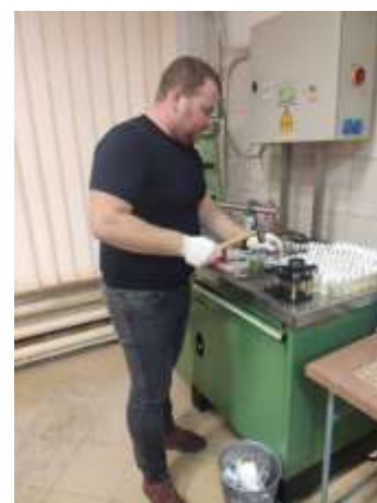
c) extragerea lubrifianțului și bilelor din cupă, după testare
