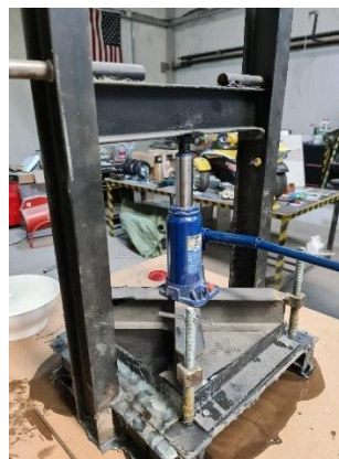
Fig. 4.9. Presă pentru fabricarea compozitului OGe, în poziția de presare
