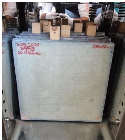
Fig. 4.11. Aranjarea plăcilor în etuvă, cu distanțiere de lemn setul de panouri cu 20 straturi
