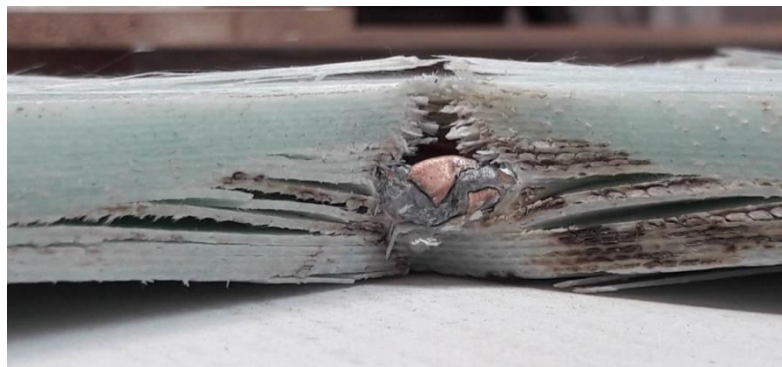
Fig. 1.6. Compozit cu fibră de sticlă și rășină, de grosime 13 mm, după impact cu proiectil de 9 mm FMJ, la viteza de 420 m/s [22]
