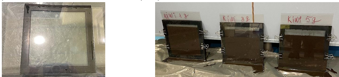
Fig. 2. Matrițe din foi de sticlă și cauciuc
