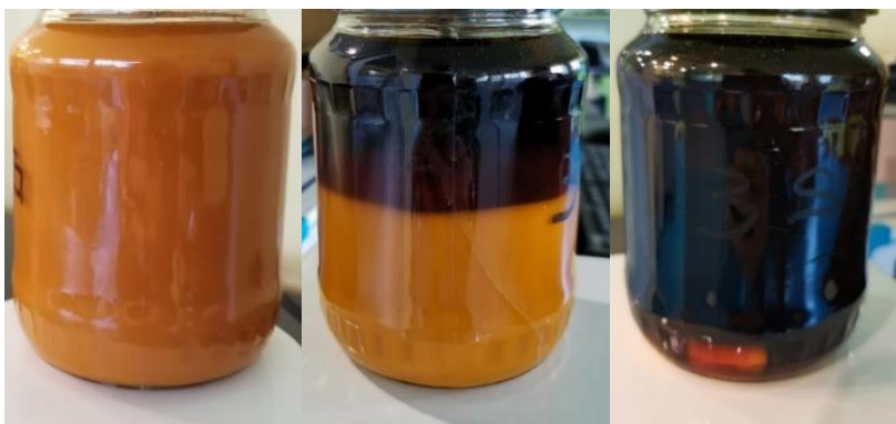
Fig.3.3. Amestecurile pentru formarea probelor cu cloruri metalice C în ziua 1, ziua 31, ziua 51 (de la stânga la dreapta)
