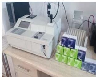
Foto 3.6. Analizorul chimic VetTest® și kituri compatibile pentru determinarea parametrilor serici (foto original)
