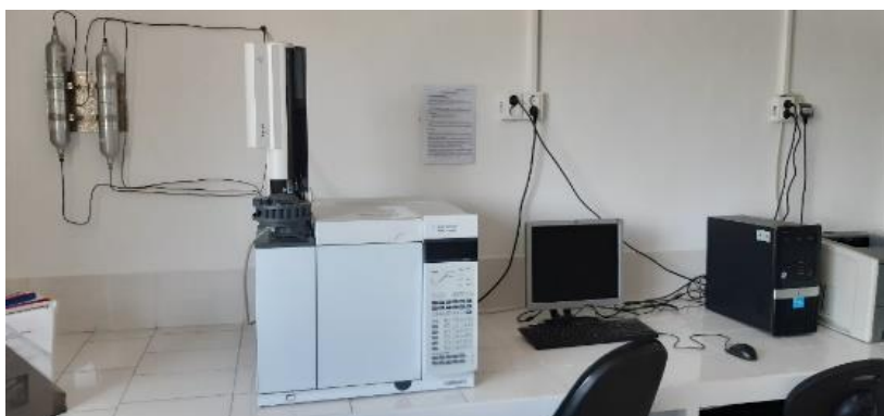
Figura 2.33. Gaz Cromatograful Agilent 7890A – SetCar S.A. Brăila
