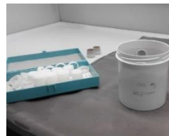
(a) (b) Figura 2.10. Prepararea și încapsularea probelor de deșeu solid cu conținut de mercur și săruri de mercur
