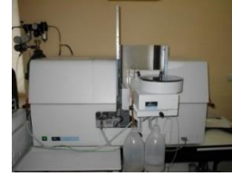
Figura 2.25. Spectrometrul AAS AAnalyst800 din laboratorul IGS, Chișinău, Republica Moldova (sursă: adaptare după [Ene ș.a., 2019c])
