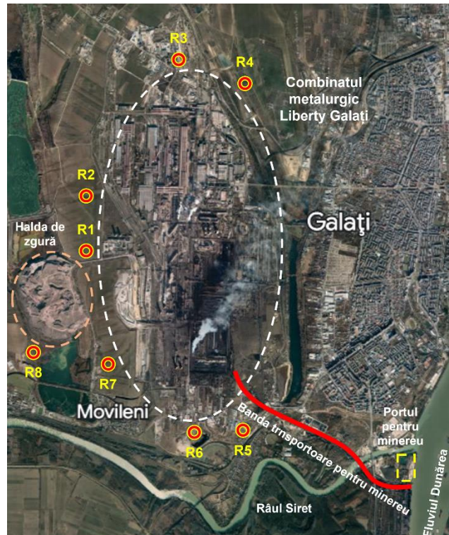
Figura 2.8. Harta de prelevare a celor opt probe de sol din imediata apropiere a combinatului metalurgic Liberty Galați (sursă: prelucrare după [Ene ș.a., 2018a], [Ene ș.a., 2023a, b], [Sloată și Ene, 2018e])
