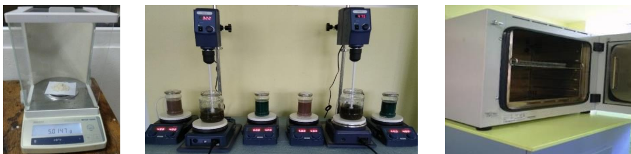
Fig. 1 Balanța electronică (stânga), soluțiile mixte în rășina vinilesterică modificată epoxi novolac, etuva pentru consolidare termică (dreapta)
