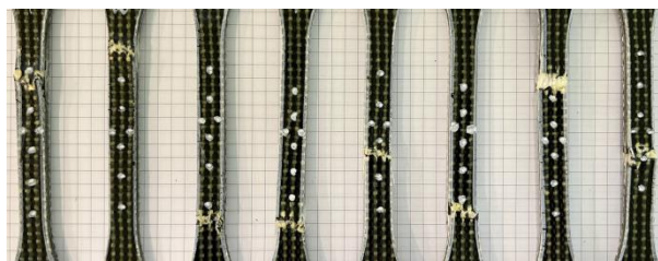
Fig. 4.19. Curbele \sigma/\epsilon și epruvetele testate pentru materialele DM
