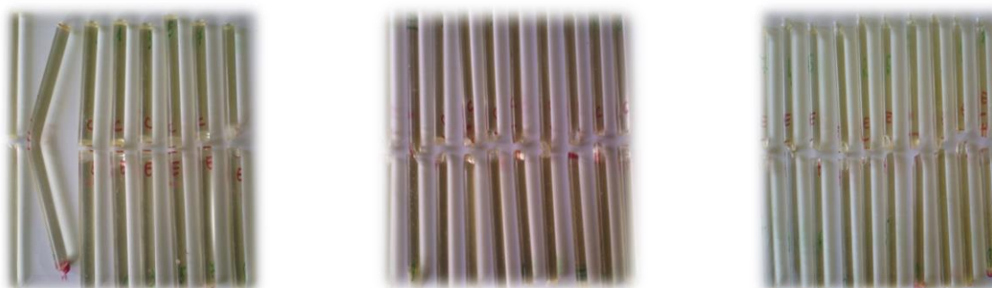
Fig. 6.3. Epruvetele testate la încovoiere în trei puncte (materiale care conțin joncțiuni – CE, CH, EH)
