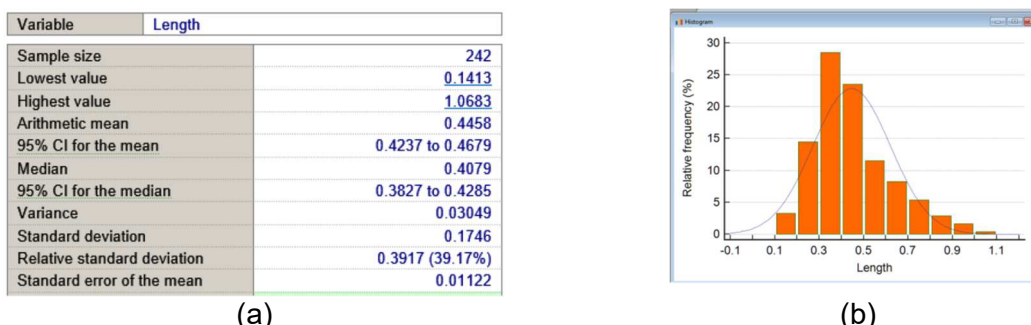
Figura 3.27. Analiza statistică a dimensiunilor particulelor de nisip: (a) valori parametri statistici; (b) distribuția valorilor
