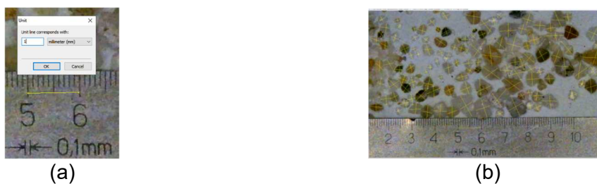
Figura 3.26. Determinarea dimensiunilor particulelor de nisip: (a) etalonarea imaginii; (b) stabilirea dimensiunilor particulelor
